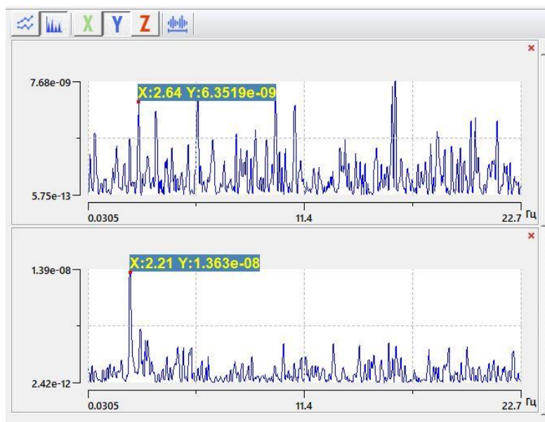
Рисунок 8.1.8 – Спектр колебаний, датчики 1 и 2 по оси Y фиксируют резонанс
